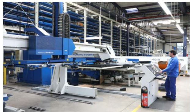
Abbildung 5: Herstellung einer Platine durch Stanzen bei apra-norm; die Steuerung erfolgt am Bildschirm.
