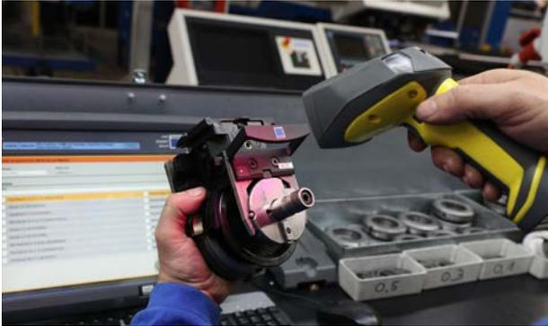
Abbildung 4: Durch Scannen entsteht eine Durchgängigkeit vom Zeichnungssatz bis zur Eingabe in die Maschine.
