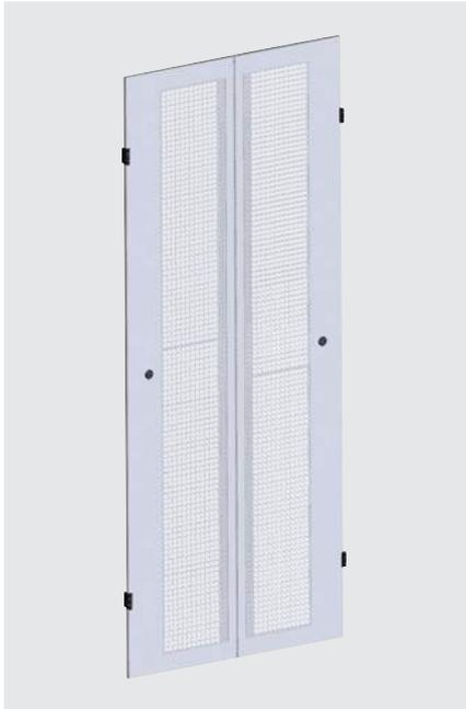
Die Tür ist geteilt und zu 82% perforiert. Dies dient der passiven Belüftung des NETcell-Systems. Die Türen können jeweils einzeln über Vorreiberverschlüsse abgeschlossen werden. Durch die beiden Türen wird die gesamte Schrankfront inklusive der Kanäle abgedeckt.
