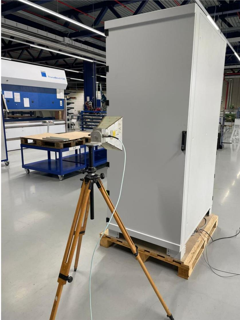
Abbildung 5: Empfangsantenne, 1 GHz bis 18 GHz
