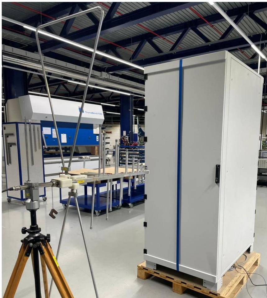
Abbildung 4: Empfangsantenne, 30 MHz bis 1 GHz, mit Spanngurten
