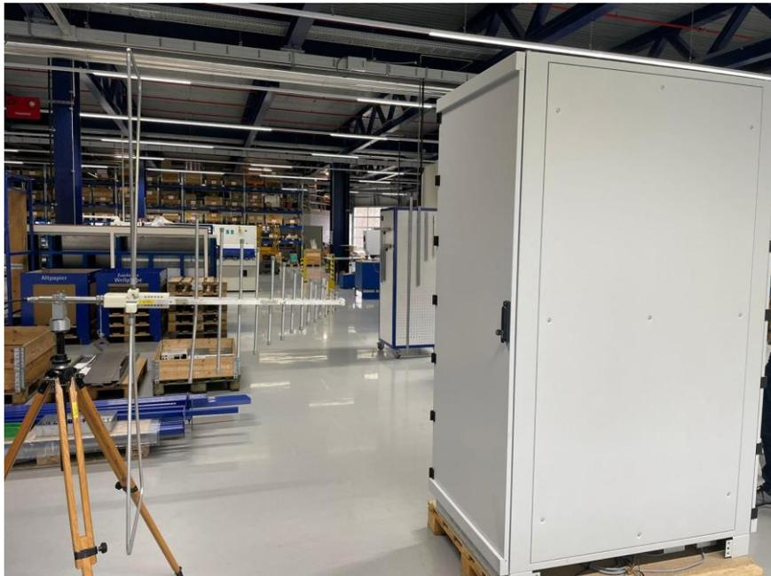
Abbildung 3: Empfangsantenne, 30 MHz bis 1 GHz
