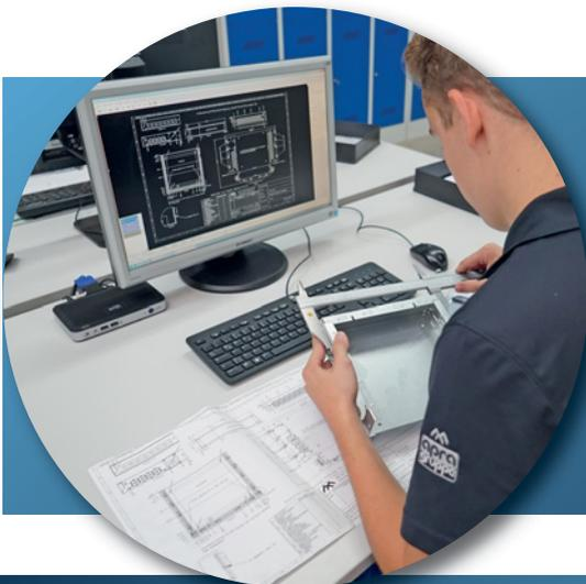
Technische/r Produktdesigner/innen entwerfen und konstruieren Bauteile, Baugruppen oder Produkte nach Kundenwunsch. Für die Erstellung von 3D-Datenmodellen nutzen sie CAD-Systeme. Sie wählen Werkstoffe, Normteile sowie Fertigungs- und Montagetechniken aus und beachten dabei Kostenaspekte sowie technische und gestalterische Anforderungen. Zudem erstellen sie die technische Dokumentation.
