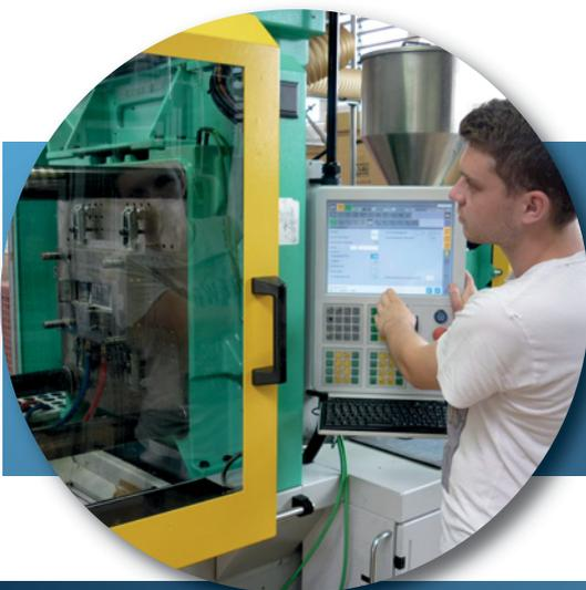
Verfahrensmechaniker/innen für Kunststoff- und Kautschuktechnik stellen Produkte aus Kunststoff her. Dazu verarbeiten sie Werkstoffe maschinell und mit der Hand, überwachen die Fertigungsverfahren und kontrollieren die Ergebnisse auf Grundlage strenger Qualitätsvorgaben.
