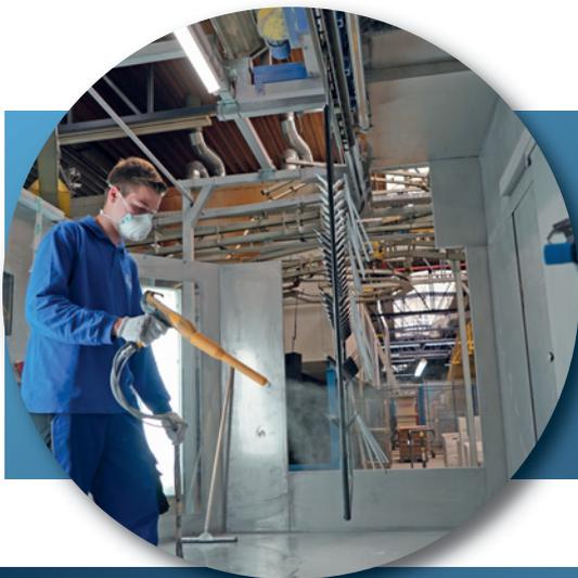
Verfahrensmechaniker/innen für Beschichtungstechnik bereiten Werkstoffe aus Metall, Stahl oder Kunststoff für die Beschichtung vor, indem sie Oberflächen reinigen und entfetten. Sie wählen Farbstoffe und andere Beschichtungsstoffe aus, programmieren die Anlagen, überwachen den gesamten Fertigungsprozess und korrigieren mit der Handspritzpistole.
